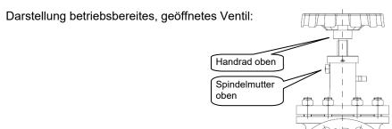
Sollte das Ventil ohne Anliegen einer Versorgungsspannung in offener Position verriegelt werden sollen, so ist hierfür ein Arretierungsstift am Auslöser vorgesehen. Dieser Stift wird bei gezogenem Handhebel in die dafür vorgesehene Bohrung eingeführt. **ACHTUNG: In diesem Zustand ist das Ventil nicht mehr auslösbar!** Im Auslieferungszustand ist an jedem Ventil ein Arretierstift vorhanden, der im eingebauten Zustand vor Ort zu belassen ist.
